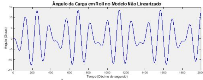
Figura 18: Ângulo da carga no modelo não linearizado do Roll
