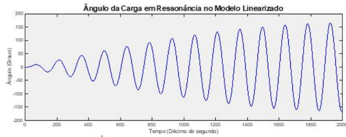
Figura 25: Ângulo da carga no modelo linearizado do Sway na ressonância
