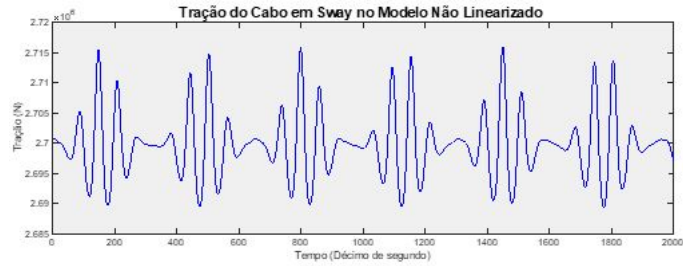
Figura 15: Tração no Cabo no modelo não linearizado do Sway
